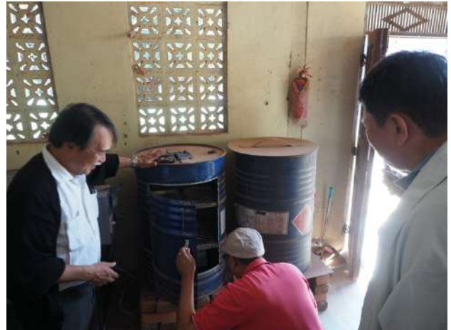
木材乾燥機の普及型モデル：火力式と説明を行う当会理事長(2020年1月、写真左)
