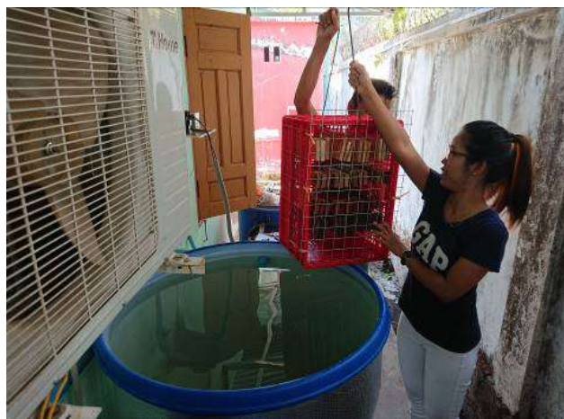
木材乾燥試験:ボイル(2019年3月)
