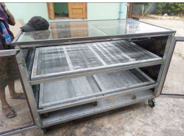
木材乾燥機の試作機:乾燥ボックス(2019年3月)
