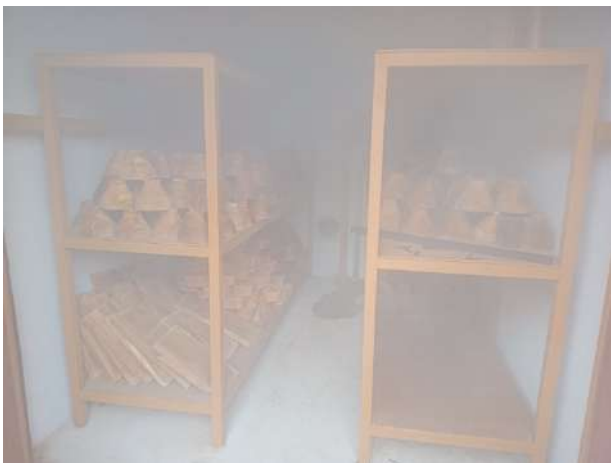
スチーム乾燥時の乾燥機内部の様子
