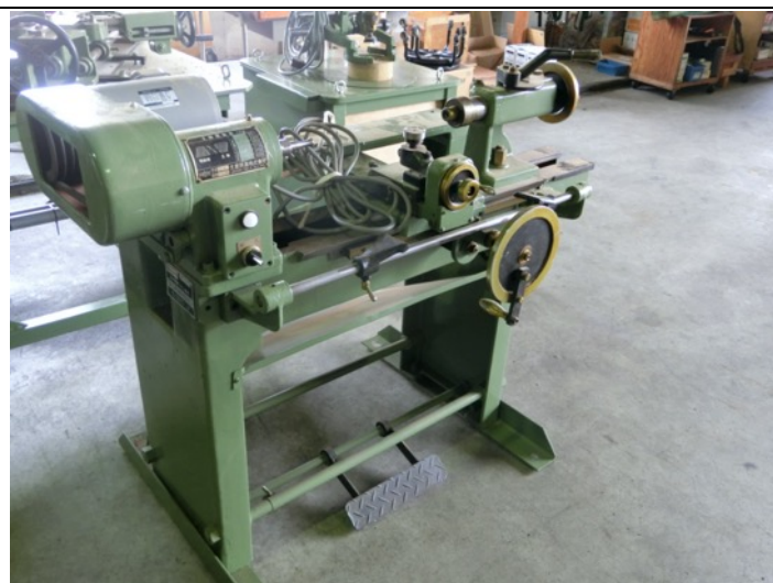
旋盤成形とその複製が可能となる「倣い旋盤」
