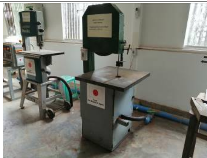
正確な加工ができるように天板を厚い鉄板に付け替えた バンドソー
