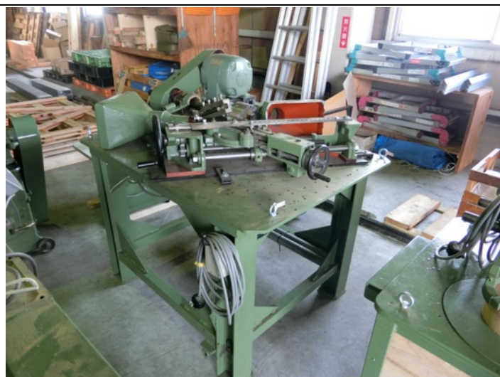
木製チャックが付属し、固定跡のない旋盤成形とその複製が可能となる「倣いろくろ」
